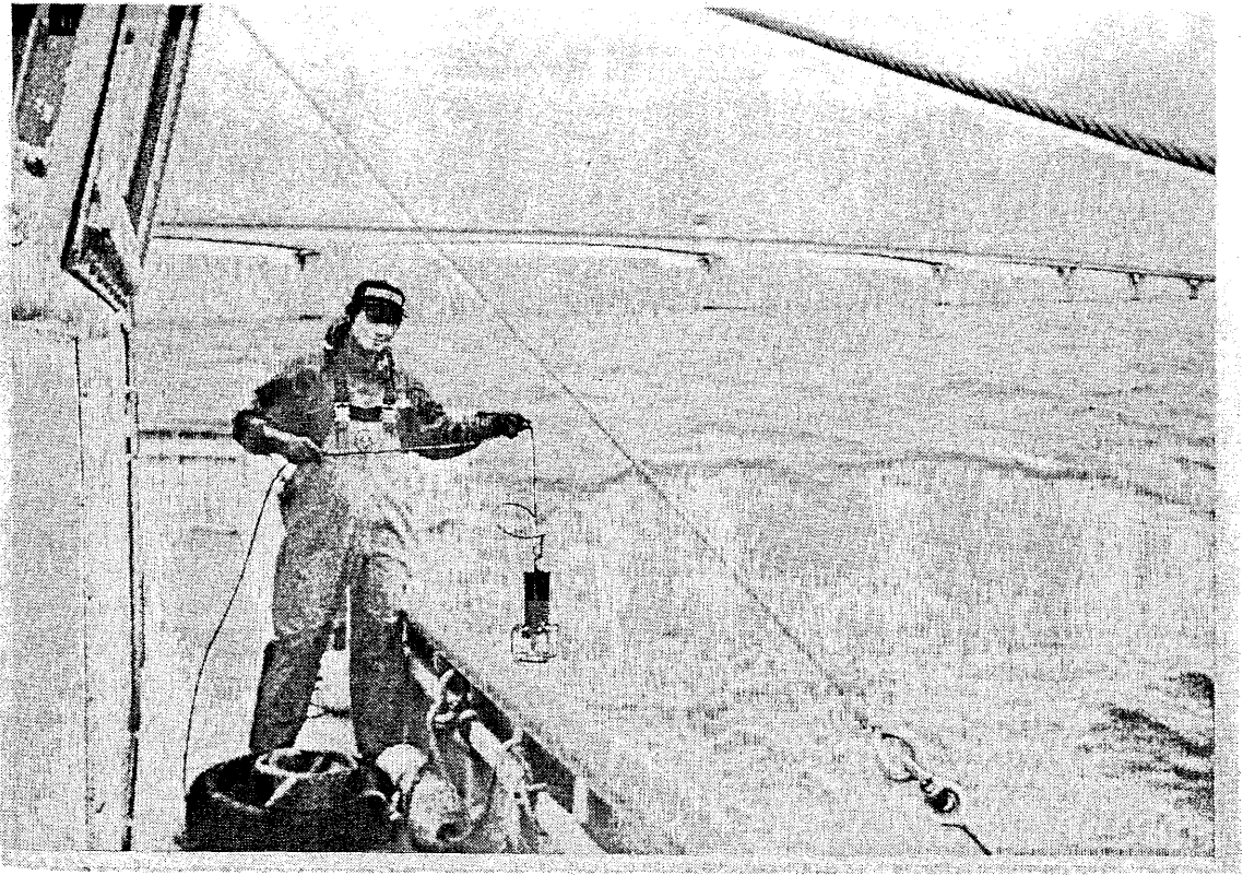
図17 青潮発生調査にて測定機器 (DOメーター) 投入
