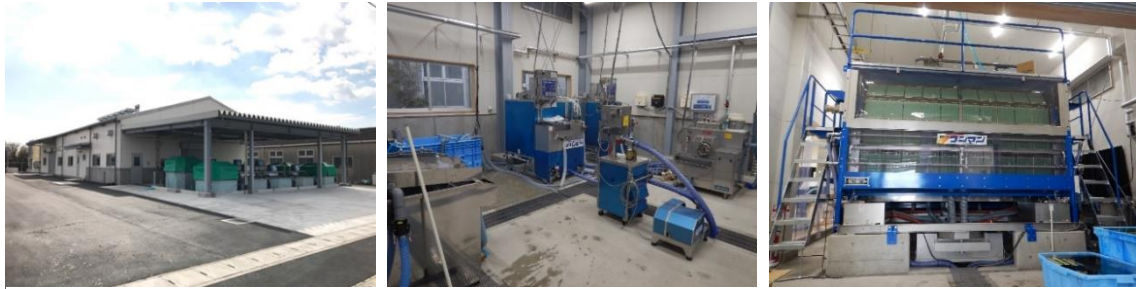
図5 ノリ共同加工施設の整備状況 (左) 施設全景、(中央) ノリ洗浄機・異物除去機、(右) 全自動ノリ乾燥機
