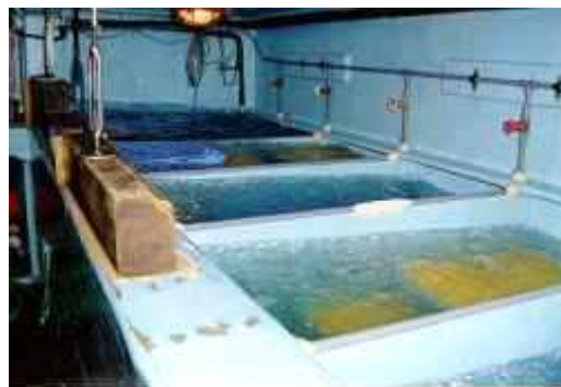
写真5 船内でエビの鮮度を保持する水槽
