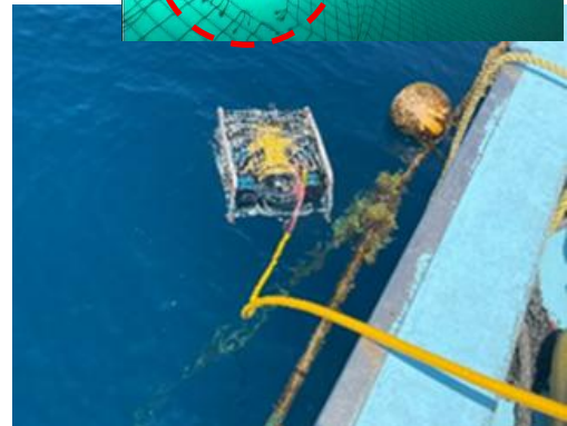
図10 水中ドローンを使った網点検
