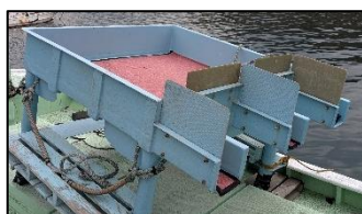
図10 魚沈静化装置(選別台に設置)
